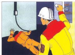
Освобождение пострадавшего от действия электрического тока в установках свыше 1000 В
