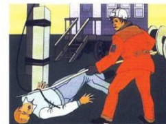
Освобождение пострадавшего от действия электрического тока в установках до 1000 В
